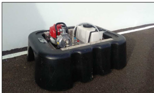
Figura 21: Bomba a motor en pontón para tratar aguas de profundidad hasta un metro.
