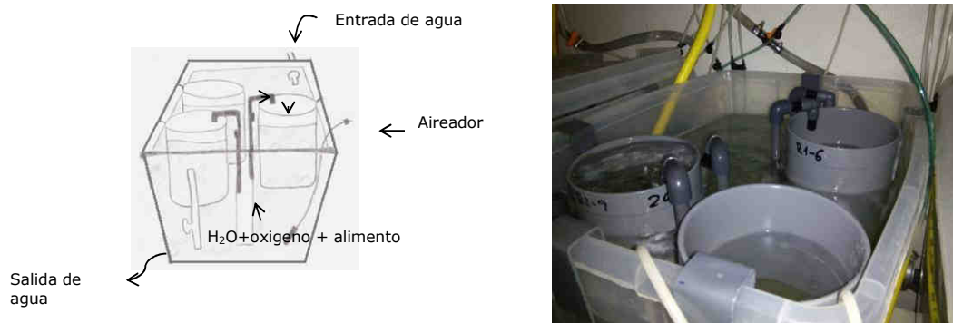
Figura 31. Diseño del sistema de recirculación interna del agua para la cría de juveniles de náyade. Tres recipientes cilíndricos con 200 juveniles cada uno se mantienen en suspensión en un tanque de 70 l con agua del lago. Dos tubos con grifos reguladores de caudal transportan agua, oxígeno y alimento verticalmente hacia el interior de los recipientes, mientras que el recipiente restante no presenta recirculación. La renovación de los tanques se da a partir de tubos de entrada y salida de agua regulados por grifos externas al sistema.
