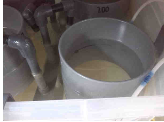
Recipiente de PVC enb acuario de 40 litros con recirculación de agua 04062015
