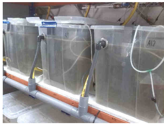
Acuariosn con recipientes de PVC y recirculación 04062015
