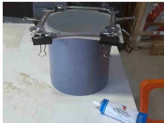
Montaje recipientes PVC con malla de 200 micras 13042015
