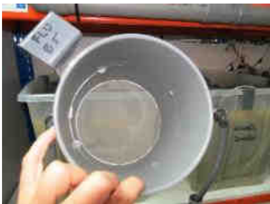
Recipiente de PVC con malla de 200 micras en el fondo listo para sembrar semilla
