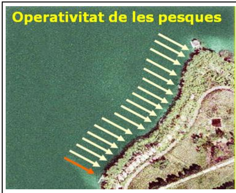
Figura 1.- Esquema de l'estratègia de maniobra de la pesca elèctrica amb barca que s'ha demostrat més adequat a l'Estany de Banyoles. Font: Pou-Rovira 2004.
