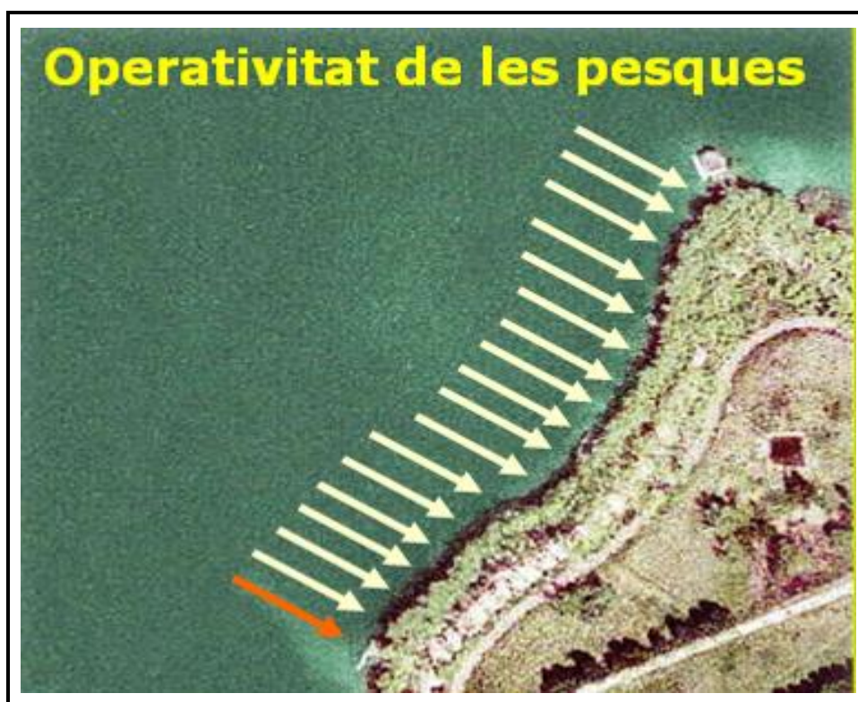
Figura 1.- Esquema de la estrategia de maniobra de la pesca eléctrica con embarcación que se ha demostrado más adecuada en el lago de Banyoles. Fuente: Pou-Rovira 2004.
